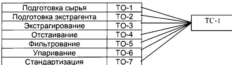
Схема 1 Технологическая схема производства густого экстракта из почек тополя бальзамического
