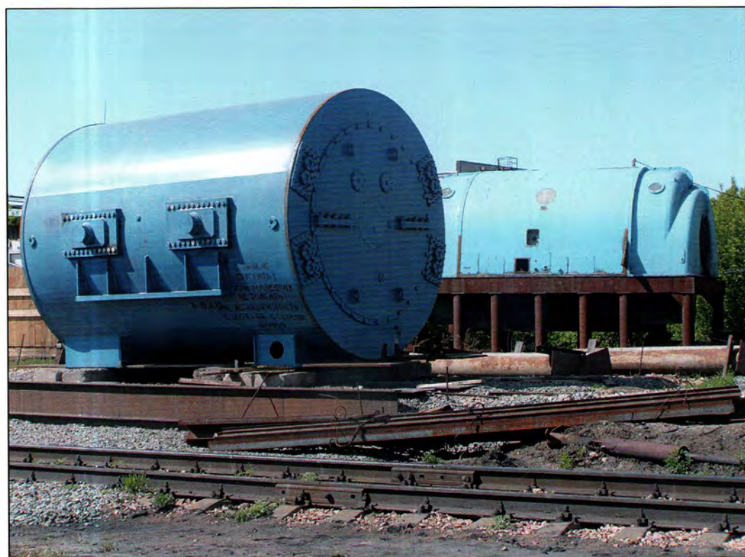
Погрузка нового статора турбогенератора № 4. 2012 год.
